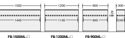
■共通仕様 本体:木製・ビニールクロス張り 上部枠:塩ビ樹脂成型品 水受皿:ステンレス製
