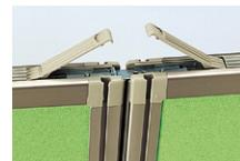
上部のピンディングレバーを起こし、スタビライザー(連結金具)を取り付けます。
