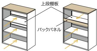
H1050タイプ、H700タイプの上段の棚板とバックパネルを前後反転させて取り付けることができます。収納物を取り出す方向が選択できて便利です。
