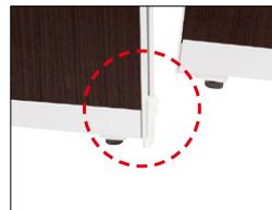
①パネル上部のキャップを外し、連結バーツを床に接するまで落としこみ、もう片方のパネルを差しこみます。
