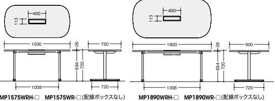
MP1575WRH-□ MP1575WR-□(配線ボックスなし) MP1890WRH-□ MP1890WR-□(配線ボックスなし)
