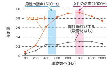
吸音効果を備えたパネル構造で、特に男性と女性の話し声である周波数帯(500～1000Hz)の吸音率が高く、周囲への音漏れを軽減してくれます。
