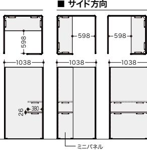
テーブルとミニパネルの取付位置は施工時に選択できます。
