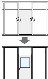
ある箇所をドアパネルに変更したい時など、ABのポール押さえのみ外すことにより、簡単に図の様な組替えが行えます。
