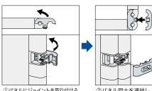
①パネルにジョイントを取り付ける。 ②パネル同士を連結し、ロックブ レートを差し込む。
