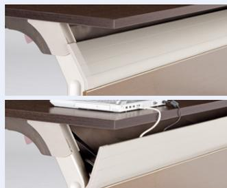
幕板上部は開閉可能な配線ダクトになっており、乱雑になりがちな配線コードを簡単に収納できます。また、天板とカバーが運動して、天板はね上げ時には自動で閉まります。
