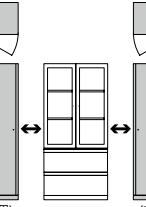
※エンドパネル及び、ロッカーは、連結方向の側面のみに連結穴が開いています。
