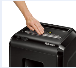
安全機能セーフセンス™ 投入口周辺に手が触れるとカッターの回転が自動的にストップする機能です。
