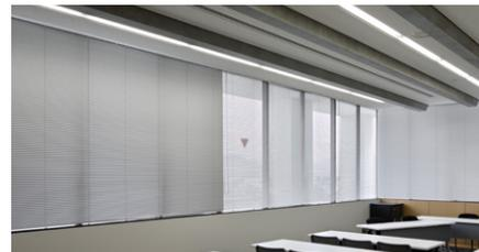
スラットには昇降コードの穴のないスラットを採用することで光漏れを防止しています。さらに、スラットの重なりを増やし遮光性を向上しています。また、全閉時のスラット角度をより垂直に近づけることで、気密性も向上しています。
