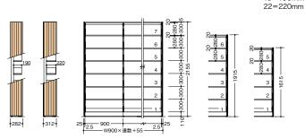
■共涌仕様 ■ - スピル は スチール焼付塗装仕上 塗装色チョコレートブラウン 支柱孔ピッチ25mm アジャスター付 固定金具付 側板:人工突板練付化粧板
